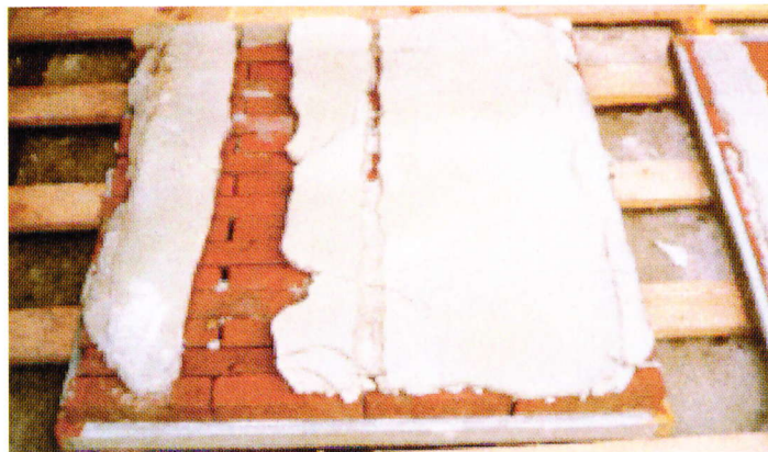
Proefstuk met baksteen/mortel (dik) na hogedruk-waterstralen.
